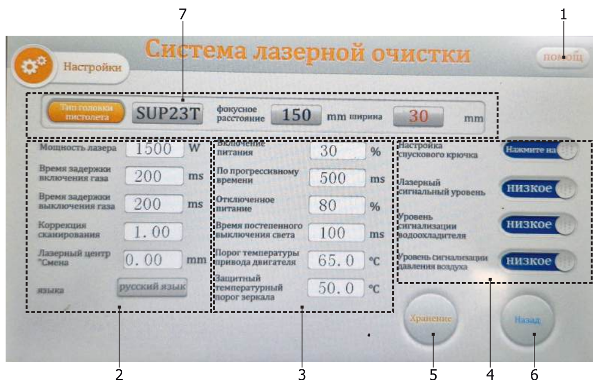
Фото 7.5 главные настройки источника с фокусирующей линзой F800.
